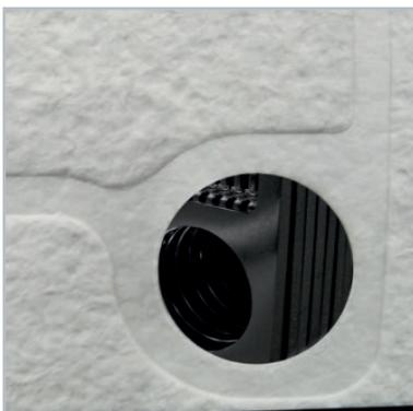
Empreinte de serrage d'un élément sur une plaque filtrante
