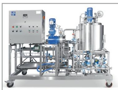
Skid de filtration complètement automatisée : ex. NOVOX® 400 incluant une unité de dosage pour adjuvants de filtration, une pompe et un système de contrôle
