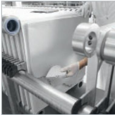
Gâteau formé sur une plaque filtrante après une filtration par alluvionnage
