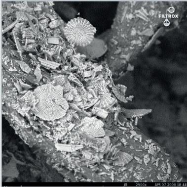
Vues au microscope électronique d'une plaque filtrante composée de cellulose (fibres) et de terres de diatomées (structures circulaires).
