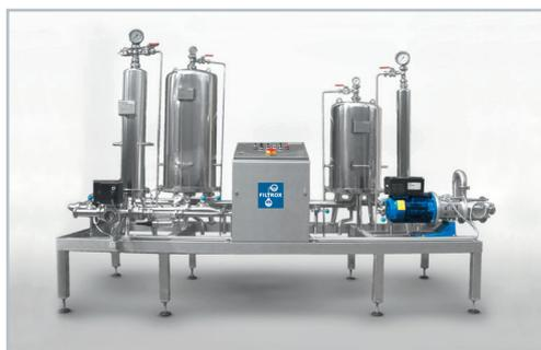
Carters montés sur un skid avec une pompe et un système de contrôle
