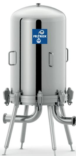
Le DISCSTAR™ P est un carter en acier inoxydable pour modules lenticulaires. Les modules permettent une filtration en profondeur à haute capacité dans un système clos. Ce système est idéal pour les applications avec des produits dangereux ou sensibles à leur environnement. La tenue en pression du carter est garantie jusqu'à 10 bars et 140°C.
